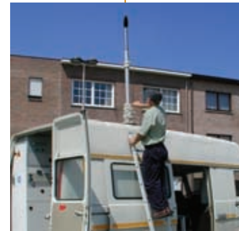
Het NMS (Noise Monitoring System) bestaat sinds 1991 en omvat 15 vaste meetposten, verspreid over een straal van 10 km rond de luchthaven, en één mobiele geluidsmetpost.
