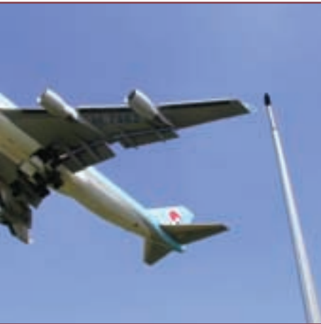
Een uitgebreid meetnet van microfoons zorgt voor voortdurende geluidsmetingen.
